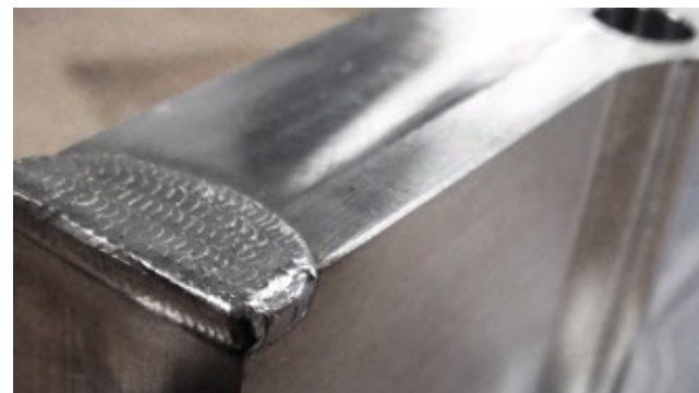
Reparação de uma extremidade de uma inserção de molde feito em bronze Ampco
