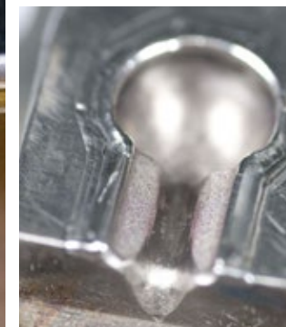
Reparação específica de arestas desgastadas
