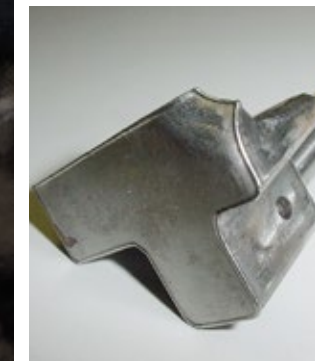
A erupção de uma aresta foi soldada no lado da ejeção de uma ferramenta de moldagem por injeção
