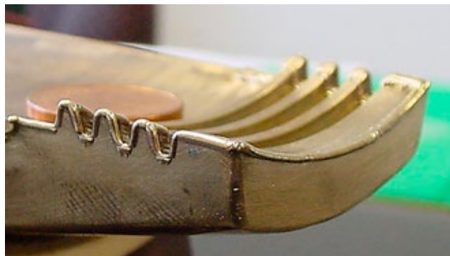
Reparação de uma extremidade de uma inserção de molde feito em bronze Ampco
