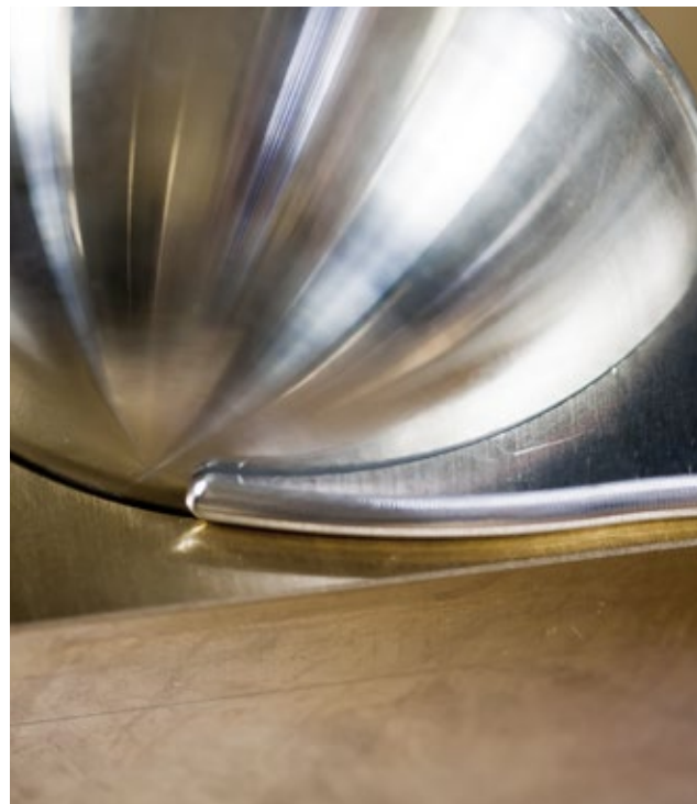
A soldadura laser também é usada na produção de peças em série (aqui peças de cata-vento)
