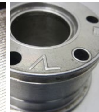
A erupção de uma aresta foi soldada no lado da ejeção de uma ferramenta de moldagem por injeção
